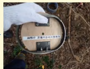
②ワイヤーを根付けし、踏み板にワイヤーをセット
