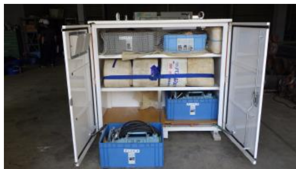
排水ポンプパッケージ（格納側）
