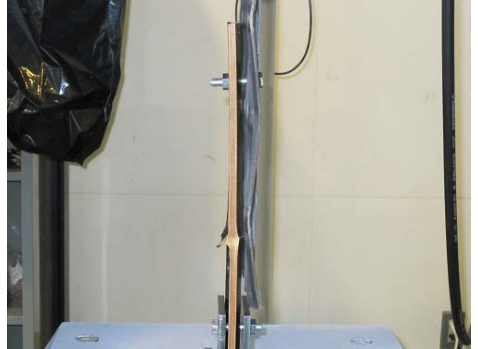
壁面材との連結部の引張試験を実施し、連結構造に問題ないことを確認しています。
