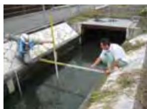
水面幅に合わせて計測するところを規定により区分し、側壁や川底などの影響を受けにくい水深に器具を設置する。
