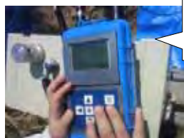
データロガー （50cm 毎にプローブの 傾きを表示・記録する）
