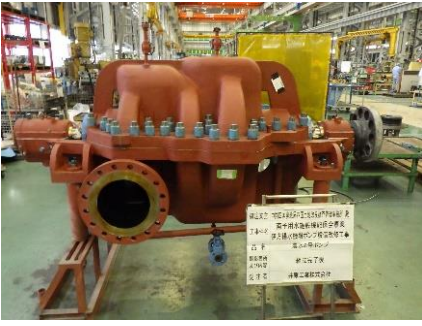
組み立て完了（塗装前）
