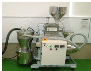
微細粒粉に製粉できる米粉製粉機
