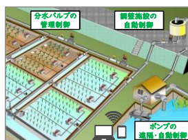
ICT等新技術の導入 （水管理の遠隔化・自動化）
