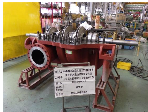
伊方揚水機場 ポンプ設備（整備後）
