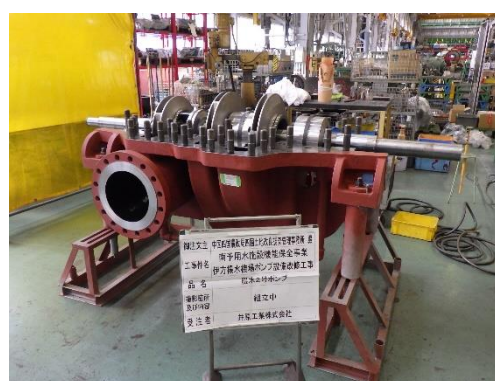
伊方揚水機場 ポンプ設備（整備後）
