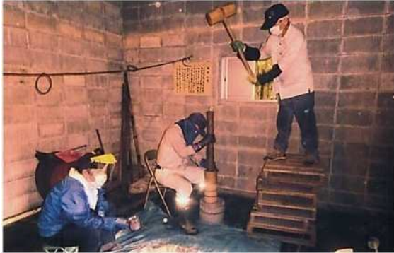
吹筒に黒色火薬を打ち込む作業
