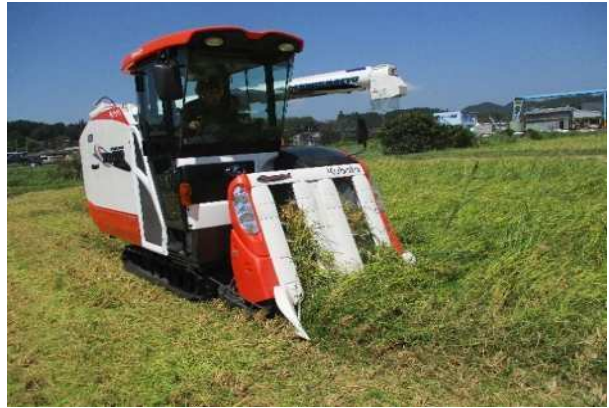
KSAS搭載のスマート農業対応型コンバイン
