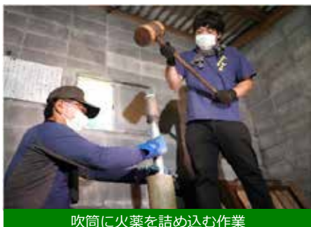
吹筒に火薬を詰め込む作業
