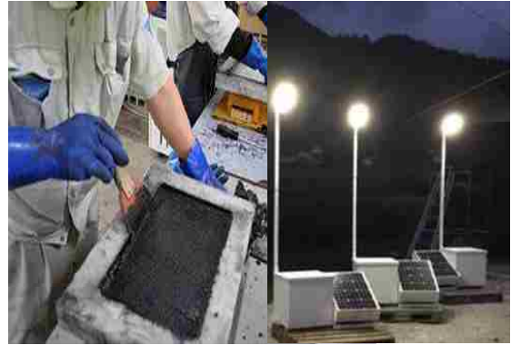
左:粉炭の成型 右:蓄電器を装着した自立照明
