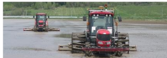
無人1台、有人1台の計2台が協調して作業を行うシステムの試験的な導入
