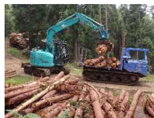
【中間土場での積卸作業】
