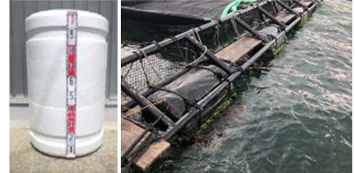
海洋生分解性プラスチックを用いたフロートの試作品と実証試験
