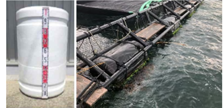
海洋生分解性プラスチックを用いたフロートの試作品と実証試験
