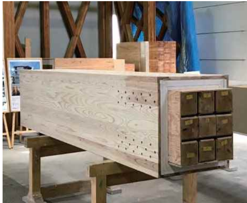
製材を束ねて石膏ボード等で被覆した木質耐火部材
