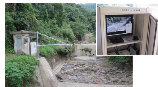
左：監視カメラと土石流センサーの設置 右上：カメラ映像 （桜島、鹿児島森林管理署）
