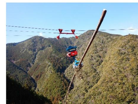
遠隔操作が可能な架線式グラップルと油圧集材機による「新たな架線集材システム」を開発
