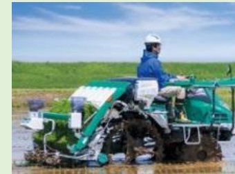
（データに基づいた可変施肥を実施）
