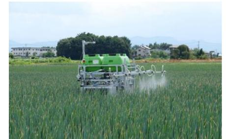
ねぎの自動農薬散布ロボット
