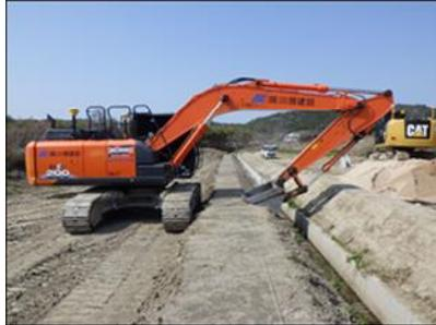
MCバックホウ(車載コントロールボックス)
