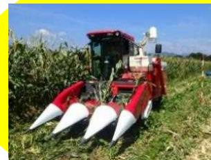
国産コーンヘッド（汎用コンバイン用トウモロコシ専用収穫ヘッド）が市販開始(R2年)
