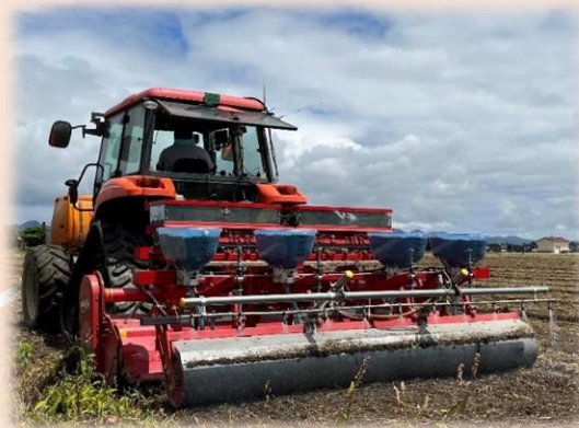
自動操舵と車速連動による高精度播種
