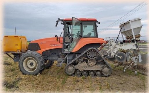
弾丸暗渠の施工(80cm間隔)と石灰窒素の深層施肥
