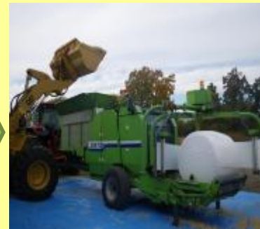
密封・梱包2 (サイレージ調製) (細断型ロールベアラ) 作業能率 1.2h/ha
