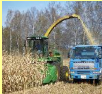
収穫 (スツパ ® ハッド ® 装備自走式ハーベスタ, ダンプトラック) 作業能率 1.5~2.1h/ha
