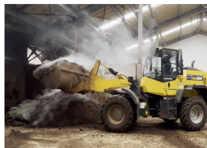
下水汚泥と返送品を混合し 水分調整する
