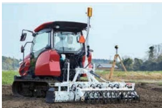
↑ レバラーでほ場を均平化しておくとも浅水代かきがしやすくなります
