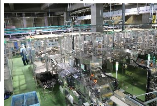
長いも洗浄選別施設 自動箱詰ライン
