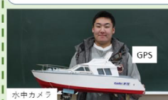
GPS 水中カメラ、GPSを装着した状態
