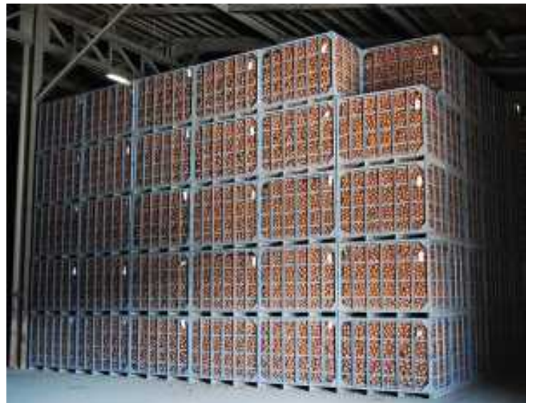
【5段積み耐えうる強度のスチールコンテナ(たまねぎ)】
