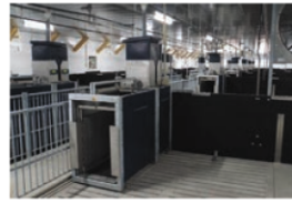
図 豚の体重と飼料摂取量を計測するパフォーマンステスター
