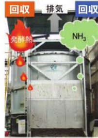
養豚における例（縦型密閉堆肥化装置）
