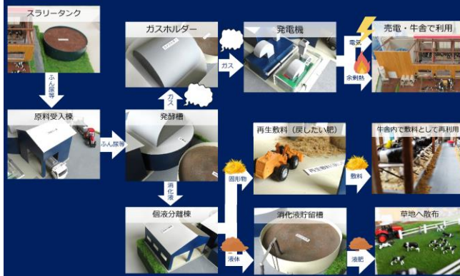
バイオガスプラントの仕組み (模型)
