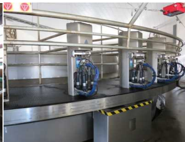
(ロータリーパーラー)(※) (※) 乳牛を乗せたターンテーブル上で搾乳する方式
