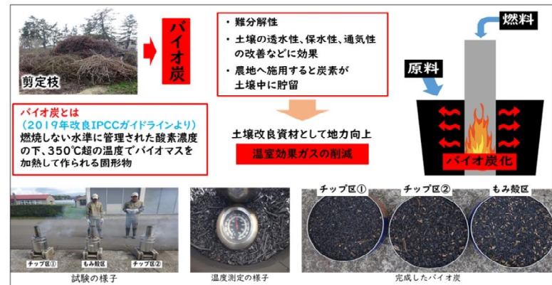
図1 バイオ炭製造試験の様子
