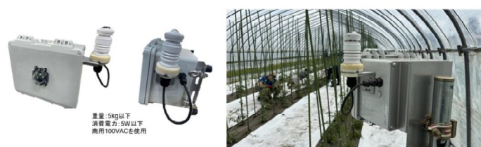
図2 環境センサー付きカメラの様子
