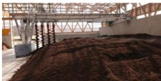
堆肥原料の自動攪拌機
