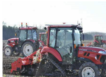
高精度位置測位情報を活用した協調型ロボットトラクターによる無人走行の実証景
