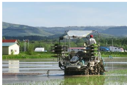
直進アシスト田植機による水稻の移植 (5月)
