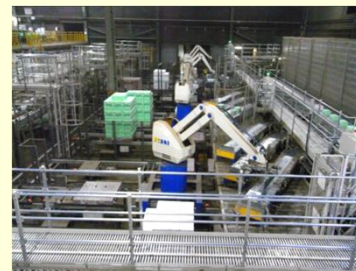
パレタイズロボット導入によるダンボール積みの自動化
