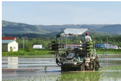
直進アシスト田植機による水稲の移植 (5月)
