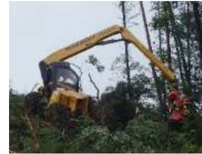
伐倒から造材まで行う 高性能林業機械（ハーベスタ）
