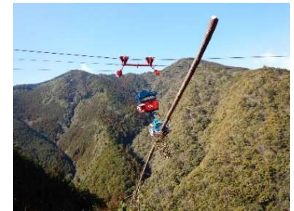
集材作業の遠隔操作が可能な 架線式グラブプルと油圧式集材機
