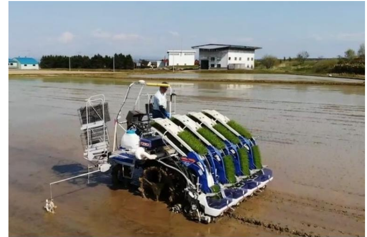
GPS機器・直進アシストを搭載した田植機による移植作業により作業労力と作業時間を削減
