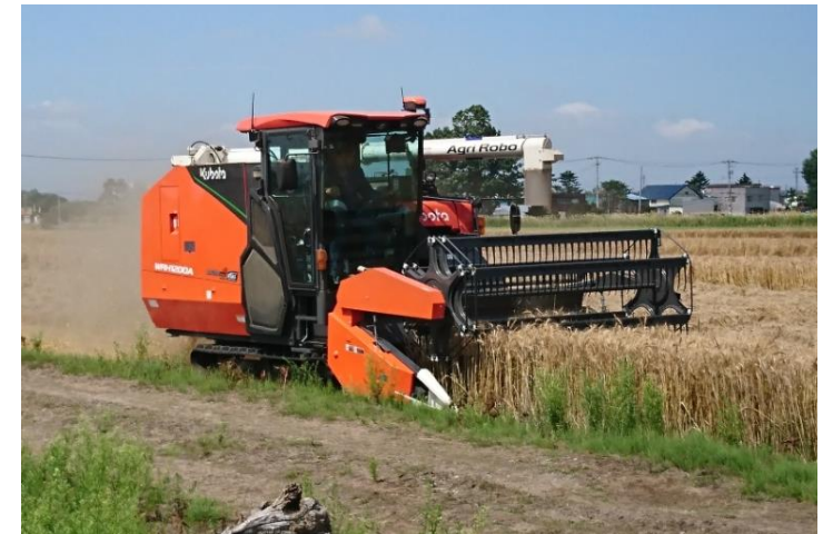
GPS機器・自動操舵を搭載した有人自動運転により作業労力と作業時間を削減
