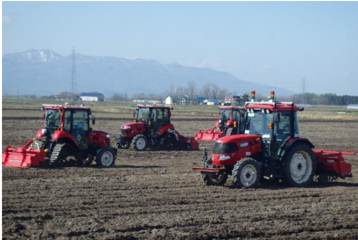
GPS機器・自動操舵を搭載した有人のトラクターと無人トラクターにより、オペレーターの人員を削減
