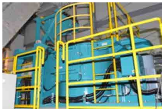
写真 2-4 バイオガスプラント全景（左） 粉砕機（右）
