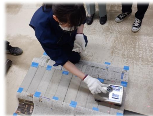
← 探査装置を用いて非破壊試験で測定を行う鉄筋探査
