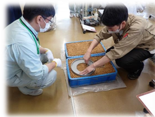
← 砂置換による土の密度試験
