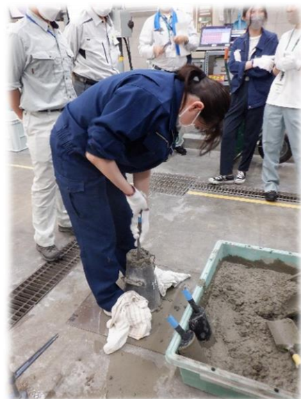
05 土が塑性体から液体に移る含水比を調べる液性限界試験
