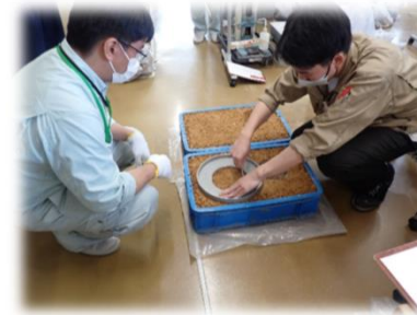
← 砂置換による土の密度試験
