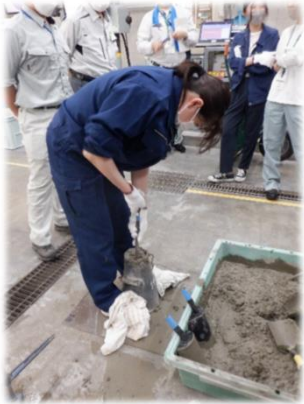
土が塑性体から液体に移る含水比を調べる液性限界試験 →
