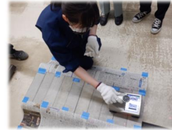
突固めによる土の締固め試験 →
