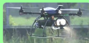
自動飛行でピンポイント農薬散布
