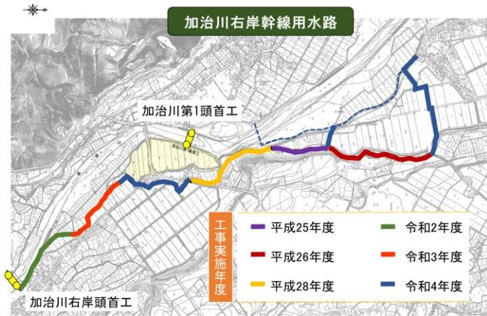
受益面積の増に伴う通水量の増に対応するため、右岸幹線用水路の拡幅が必要になり、平成25年度から総延長 3.7 kmの用水路の改修に着手しました。
