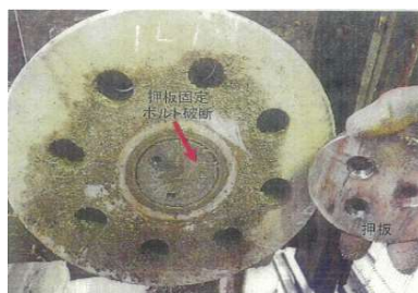
サイドルーラーの損傷
